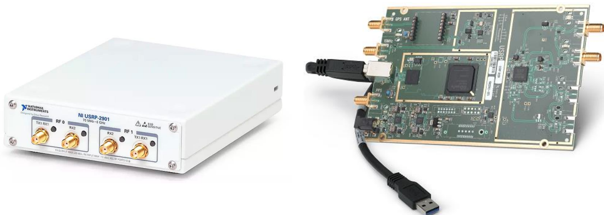
Fig. 3. Placa base de la radio Ettus Research USRP 2901 [11]. (Fuente: NI®)
