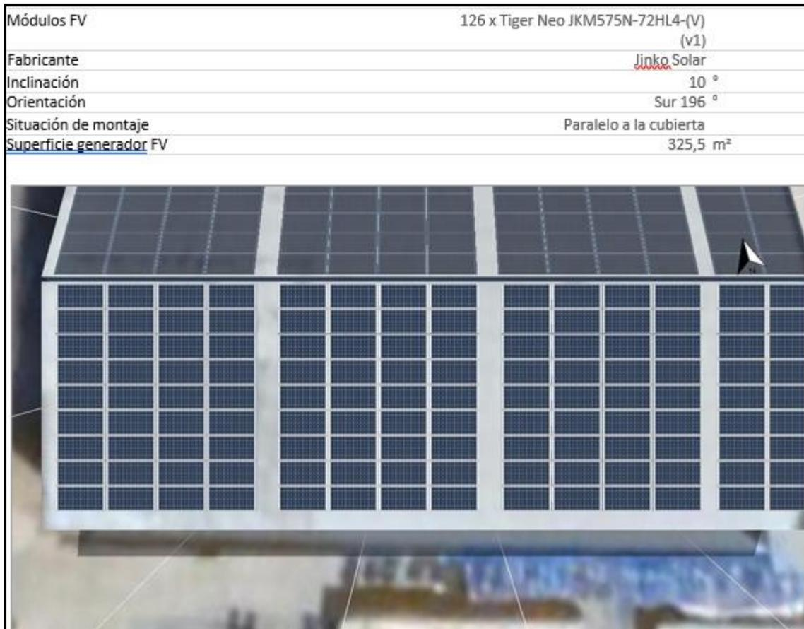
Fig. 27. Ubicación de los paneles en sentido sur.
