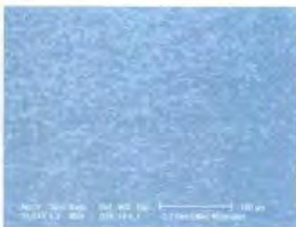
Figura 1. Imagen SEM del TiN de la probeta 8M (-100 V Bias, 20 sccm Ar y 2 sccm N<sub>2</sub>)
