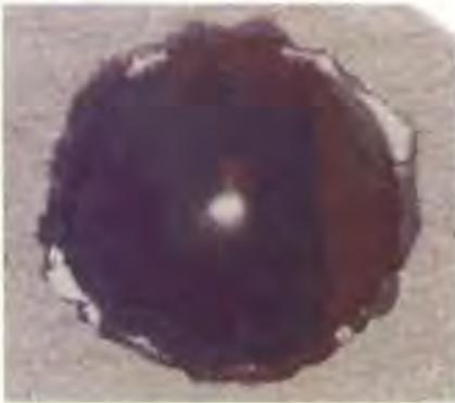
Figura 8. Adherencia del TiN de la probeta 8M mediante el método de Rockwell C (x50)
