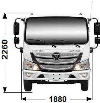
Figura 3.3 Dimensiones frontales del vehículo sin protuberancias expresadas en [cm]
