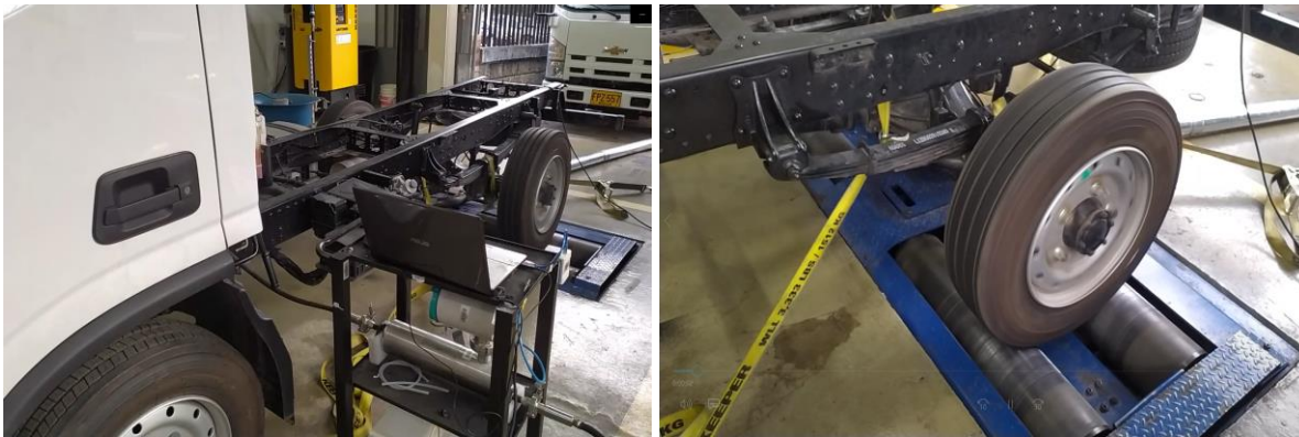
Figura 3.5 Vehículo de prueba sobre dinamómetro de rodillos
