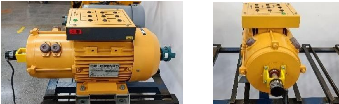
Figura 36: Sistema para la adquisición de velocidad en el eje del motor.
