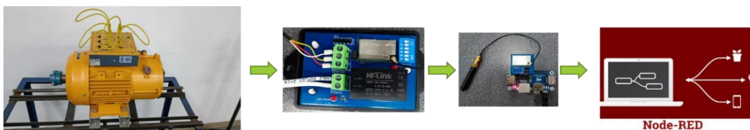
Figura 35: Componentes físicos del sistema para la adquisición temperatura en el estator del motor.
