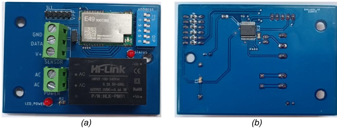
Figura 12: Tarjeta diseñada para medición de velocidad y temperatura. (a), vista superior y (b), vista inferior.
