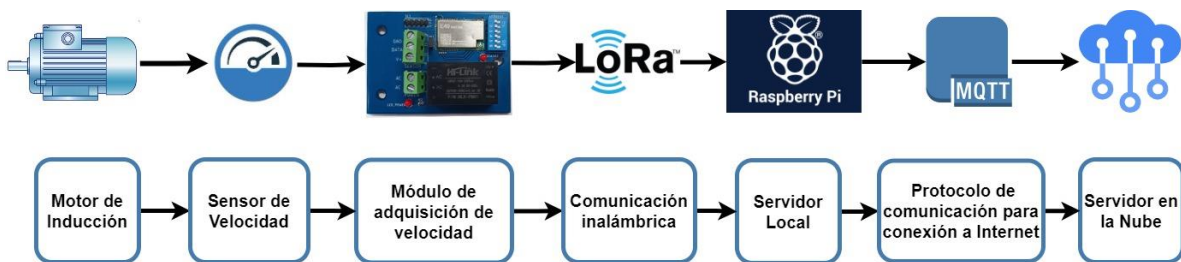
Figura 37: Topología del sistema para la adquisición velocidad angular del rotor.
