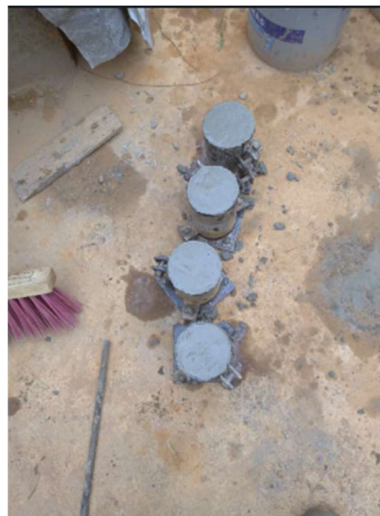
Ilustración 1: Cilindros de concreto elaborados en obra.
