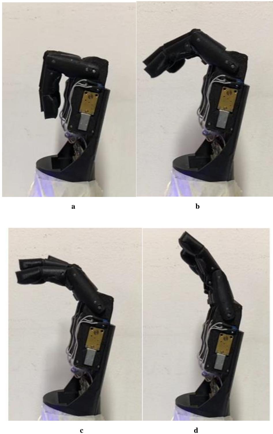
*Figura 16. Movimiento completo de la mano a. mano cerrada b. mano parcialmente cerrada c. mano parcialmente abierta d. mano abierta*
