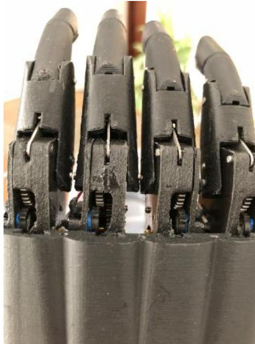
*Figura 12. Montaje de los cuatro dedos con el potenciómetro.*
