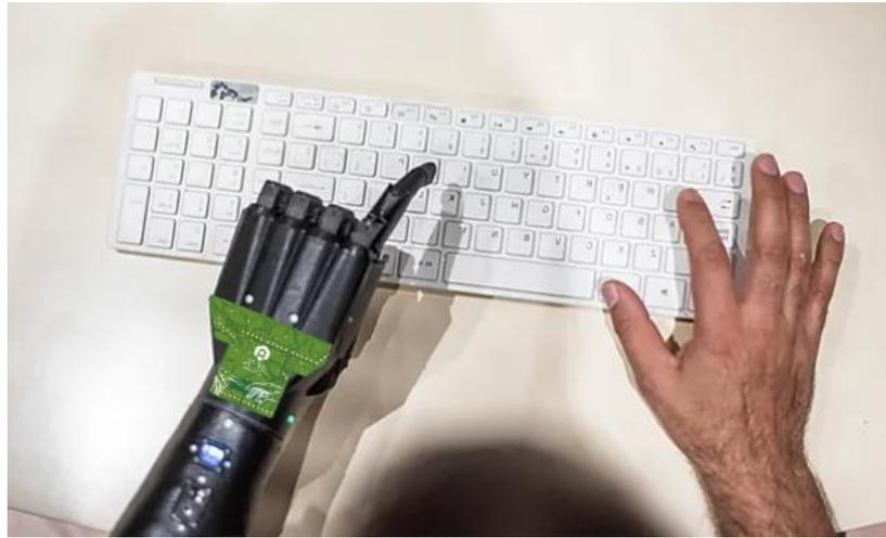
*Figura 13. Ubicación de la tarjeta electrónica*
