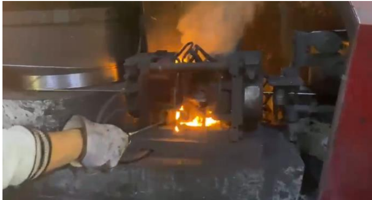
Imagen 7. Sobrecalentamiento en las caseteras
