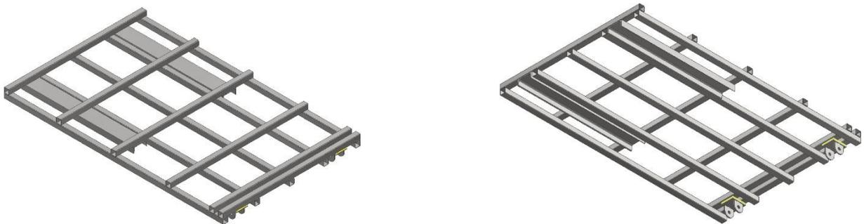
Con el objetivo de lograr un diseño versátil y adaptable a posibles cambios o requerimientos futuros, se implementó el enfoque de diseño paramétrico utilizando el software Inventor [14]. En este ensamblaje, se consideró la posibilidad de ajustar dinámicamente el ancho y largo del elevador, brindando flexibilidad para adaptarse a diferentes necesidades y escenarios operativos.
