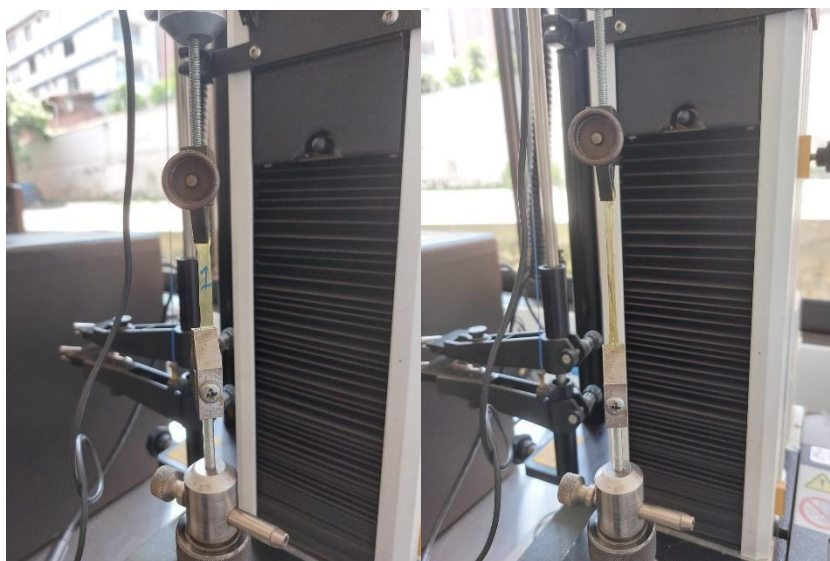
Fig. 13. Ensayo de Tracción Realizado a Películas de NIPU Para Cada Síntesis
