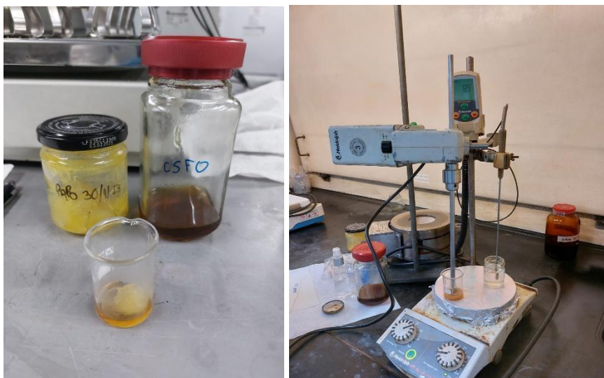
Fig. 11. Montaje Experimental Síntesis de NIPU con CSFO y PAPO
