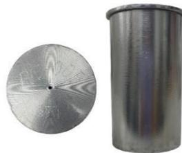
Fig. 2. Picnómetro metálico de 100ml.
