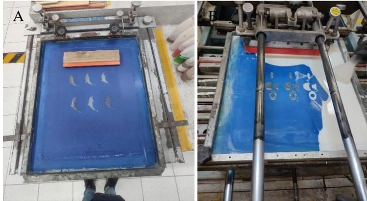
Fig. 20. A) Decoradora y espátula para aplicación manual del laboratorio. B) Decoradora automática utilizada en línea.
