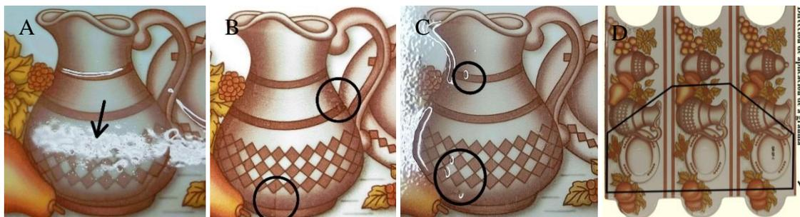
Fig. 19. A) Punzadura por hervido. B) Encharcado y marcado de malla. C) Falta de llenado. D) Zona de concentración de defectos.
