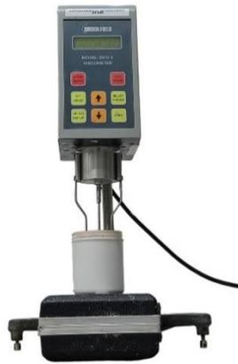
Fig. 1. Montaje para evaluación de viscosidad en viscosímetro Brookfield.
