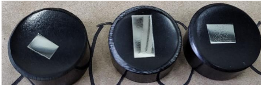
Figura 10. Muestras después del montaje en resina y proceso de pulido.
