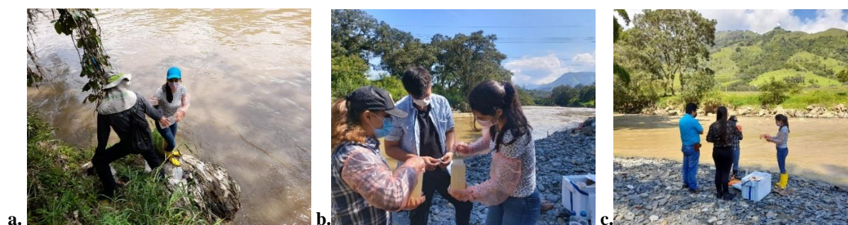
Figura 9 Muestreo en aguas superficiales: a. Recolección de muestras; b. Adición de trizma y c. Almacenamiento y transporte de muestras.
