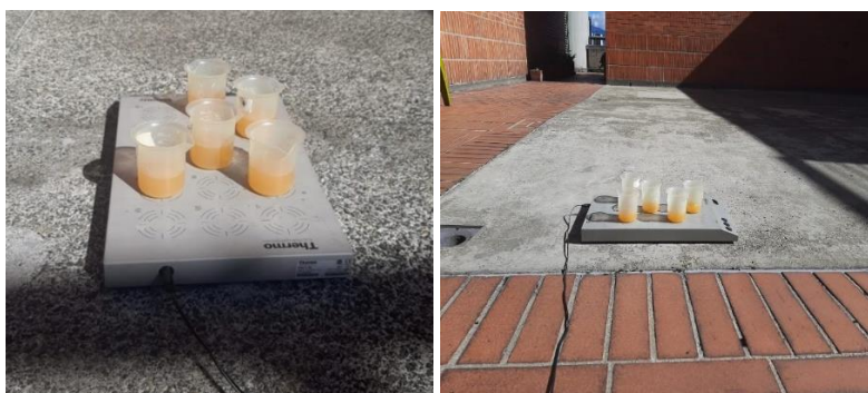
Figura 15 Remoción de PFOA empleando foto-Fenton con luz solar.
