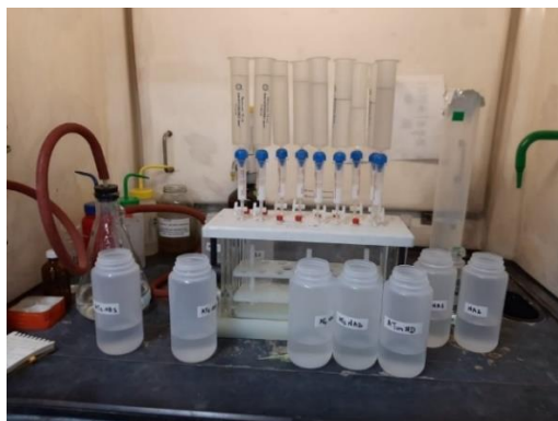
Figura 10 Montaje para la extracción SPE de PFAS.
