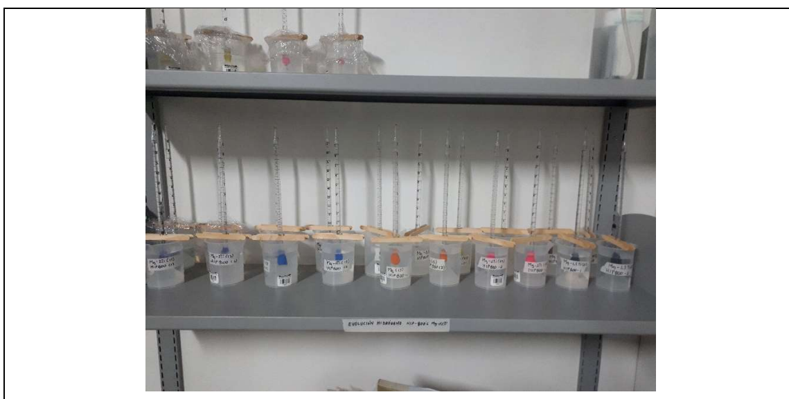
Figura 24. Evolución de hidrógeno para los materiales de matriz Mg-x% wt. Ti procesados a diferentes temperaturas de HIP.
