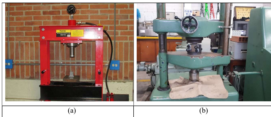
Figura 20. Prensas utilizadas para obtener materiales en verde, (a) Ferton 30T para muestras de 5 mm x 5 mm x 10 mm y (b) Prensa semi-industrial para muestras de 8 mm x 8 mm x 60 mm.
