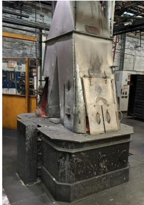
**Ilustración 8 Horno de sostenimiento**
