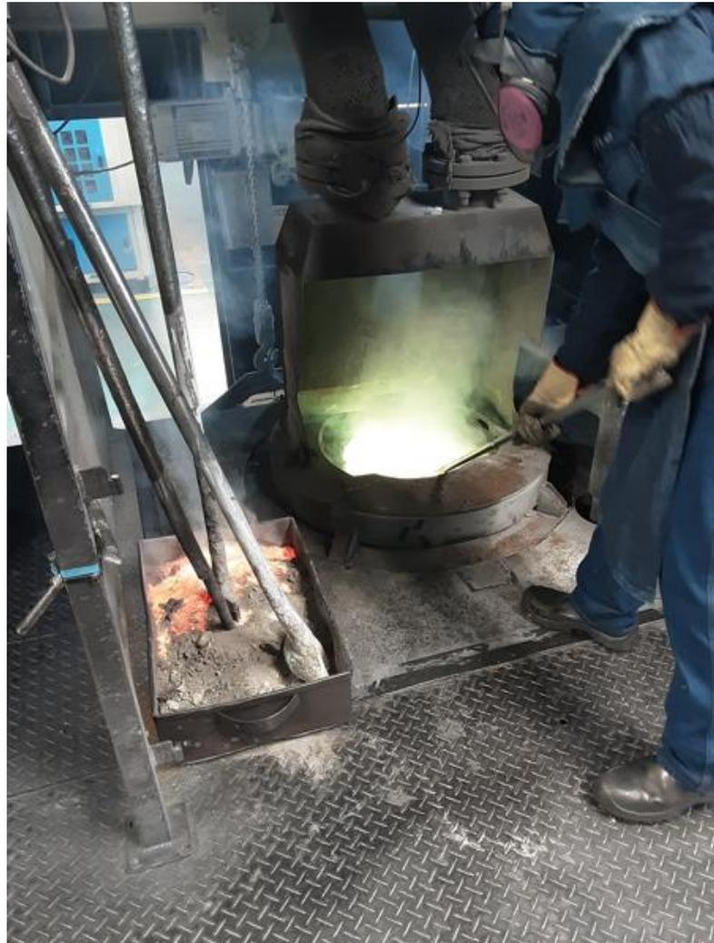
**Ilustración 6 Horno de fundición**
