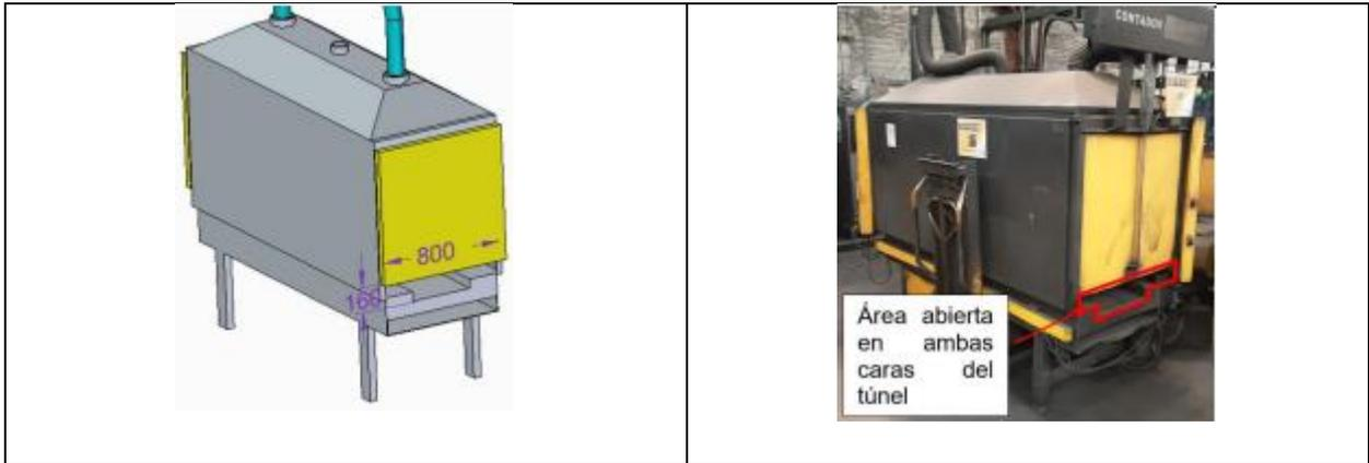
**Ilustración 40. Tomas de extracción túnel de enfriamiento**
