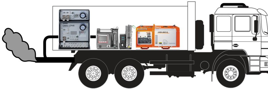
Figura 7: Montaje experimental para recolectar datos de movilidad y emisiones
