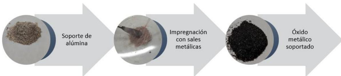
**Figura 4.6.** Proceso de obtención del óxido metálico soportado
