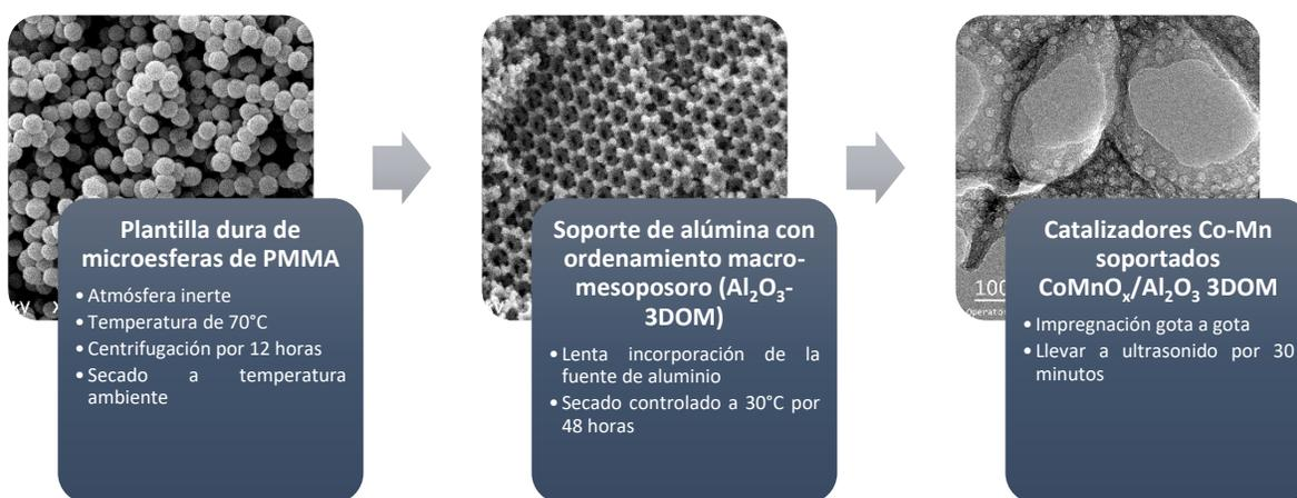
**Figura 4.1.** Resumen gráfico del procedimiento para la síntesis de los catalizadores empleados en este estudio.
