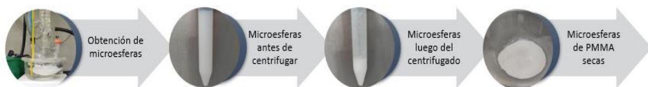
**Figura 4.3.** Proceso de obtención de las microesferas de PMMA.
