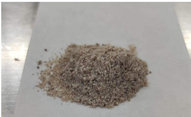
**Figura 4.5.** Polvo de Al<sub>2</sub>O<sub>3</sub> 3DOM resultado de la calcinación.
