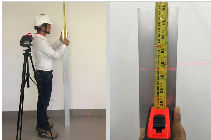
Figura 4. Medición de horizontalidad mediante nivel laser (Botero Botero et al., 2017).
