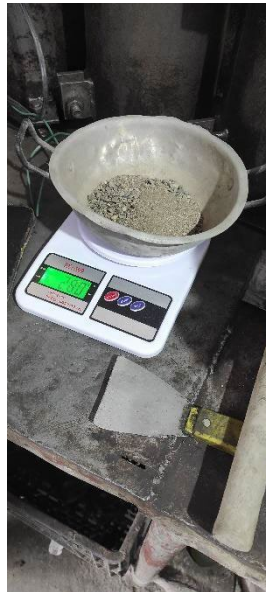
Figura 9. Procedimiento para la ejecución del ensayo de humedad en obra (Elaboración propia).
