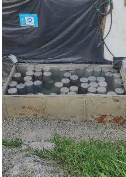
Figura 23. Almacenamiento de cilindros de concreto en obra Villa Gabriela (Elaboración propia).
