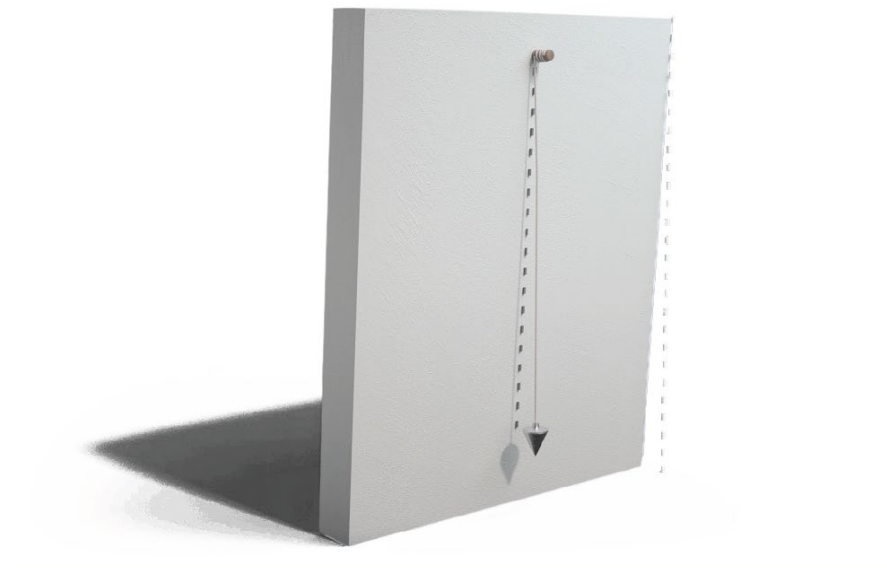
Figura 5. Ilustración de medición de verticalidad utilizando la plomada (Botero Botero et al., 2017).
