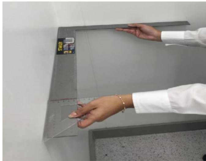
Figura 3. Medición de escuadría (Botero Botero et al., 2017).
