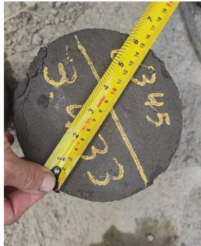
Figura 22. Verificación de medida en cilindro de concreto de la obra Villa Gabriela (Elaboración propia).
