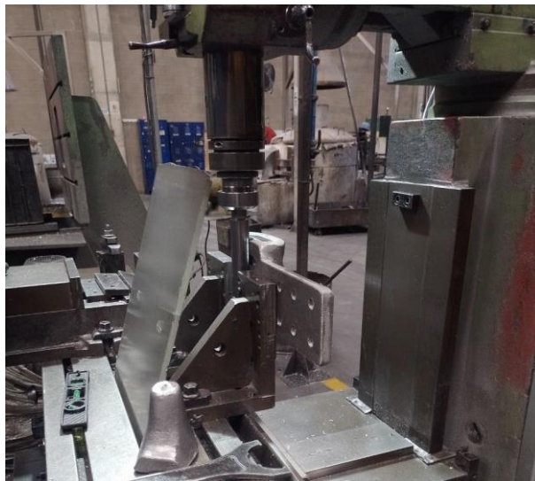
Fig. 9. Proceso de mecanizado para radios.
