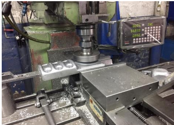
Fig. 7. Proceso de planeado de platinas.
