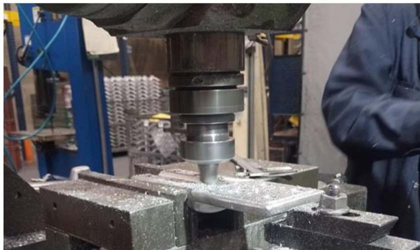
Fig. 11. Montaje para mecanizado de radio con fresa redonda.
