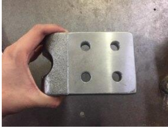
Fig. 17. Operación de perforado de platina. 4 perforaciones de \text{Ø}18 mm y espesor de 20 mm.
