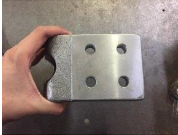
Fig. 6. Proceso de perforado de platinas.
