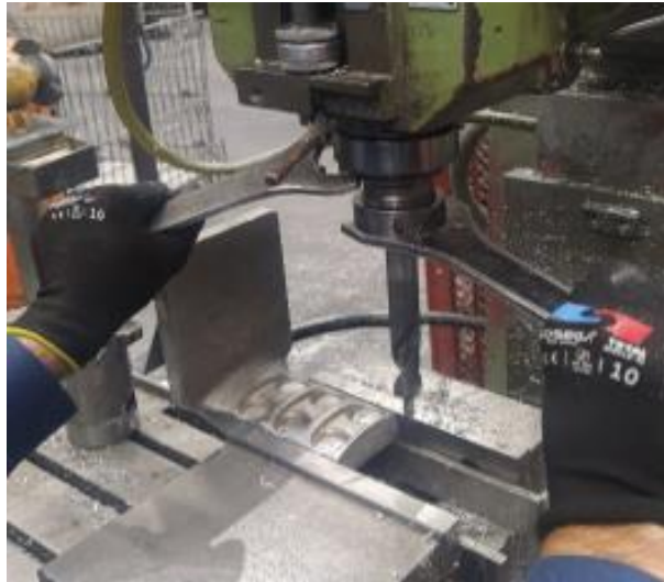
Fig. 8. Proceso de perforado para pisadores.
