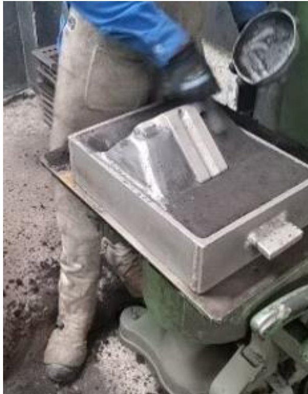
Fig. 4. Proceso de moldeo en arena verde.
