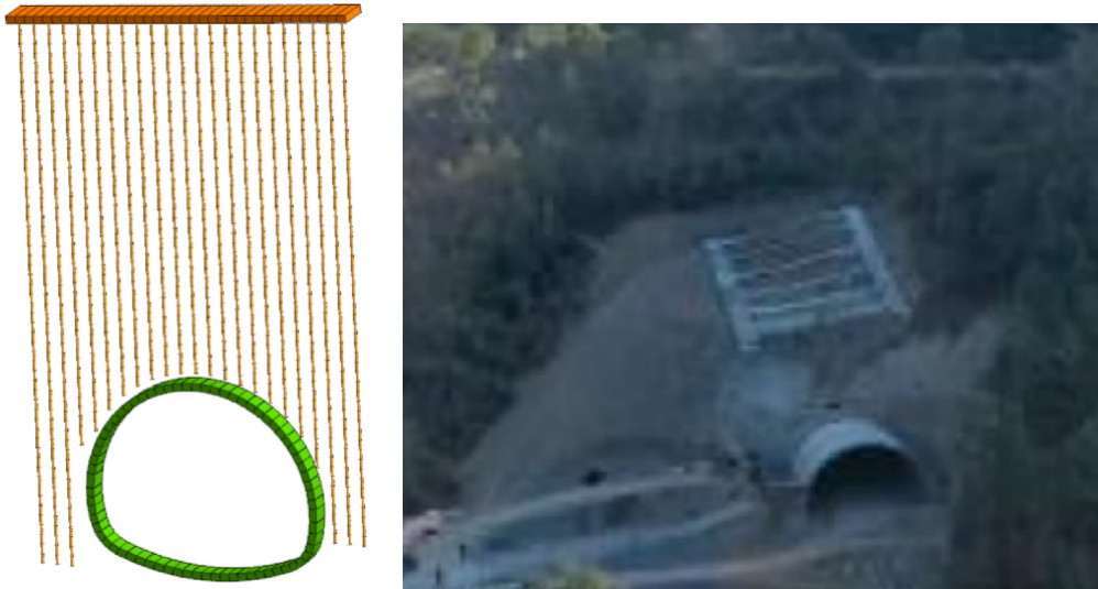
Figura 3.7: Esquema de micropilote combinado con el método de vigas acopladas [55].
