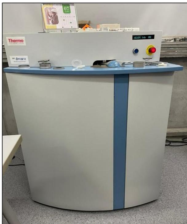
*Nota.* Equipo utilizado para realizar la fluorescencia de Rayos-X.
