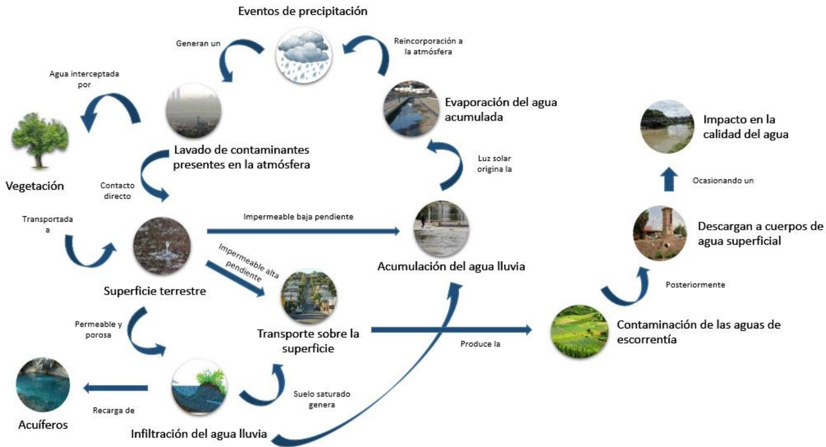
Figura 12. Procesos que se presentan en el agua lluvia y de escorrentía antes de su descarga en los cuerpos de agua superficial de acuerdo con los diferentes factores que condicionan la partición, el almacenamiento y el transporte del agua en la superficie terrestre
