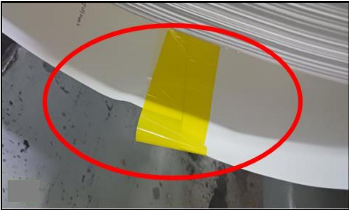
*Figura 51. Empate entre laminas con anchos diferentes [Autoría propia].*
