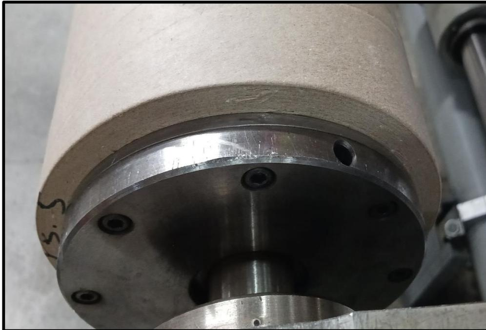
*Figura 48. Lugar de atrapamiento de la bobina laminada, ubicada entre el contacto del Core y el eje del rebobinador de la máquina [Autoría propia].*
