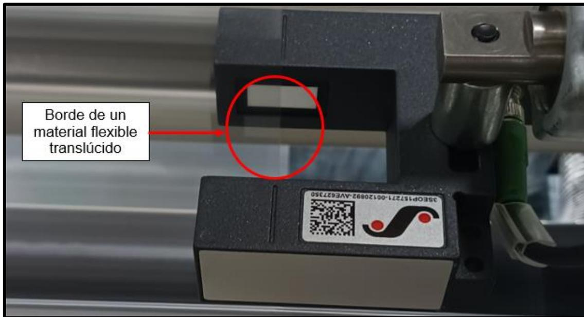
*Figura 56. Ultrasonido utilizado en el proceso de laminación de ALICO S.A.S. [Autoría propia].*
