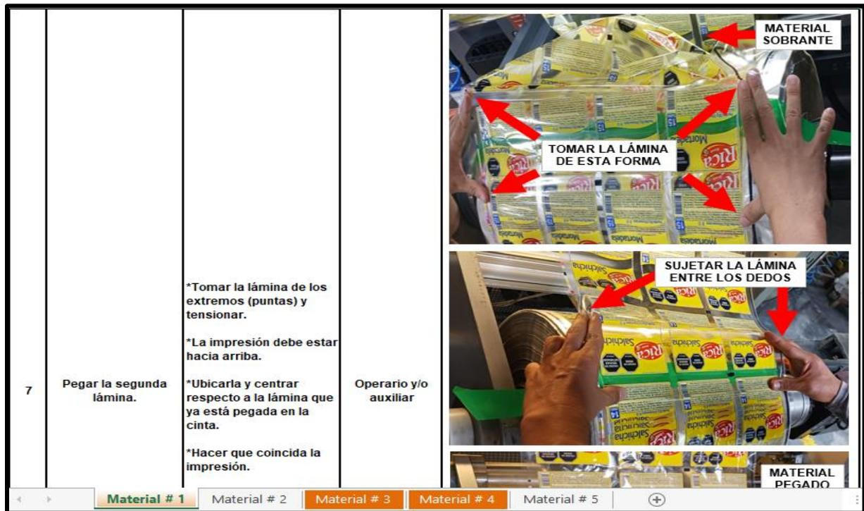
*Figura 53. Instructivos de empates por material utilizado entregados al proceso de laminación de ALICO S.A.S. [Autoría propia].*
