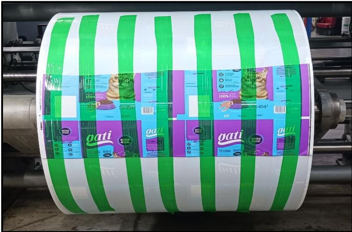
**Figura 26.** Bobina laminada de 1200 mm de ancho finalizada y empataada con 7 cintas adhesivas, bajo el seguimiento de la lección de un punto llamada “Correcto empate del material laminado terminado” entregado a los colaboradores del proceso de laminación [Autoría propia].
