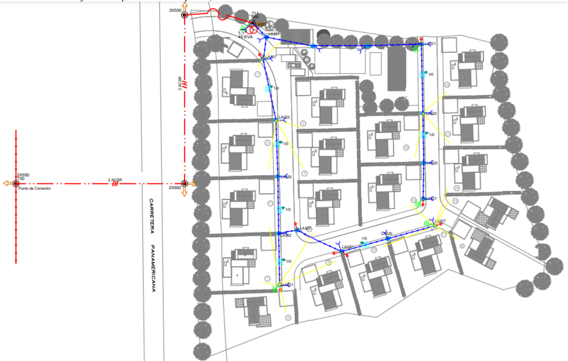
Figura 2 Plano red aérea Conjunto Campestre Nueva Esperanza
