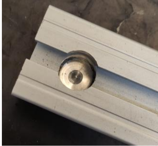
Fig. 37. Agujero para ensamble de sistema de unión entre perfiles 4040 o 4080.
