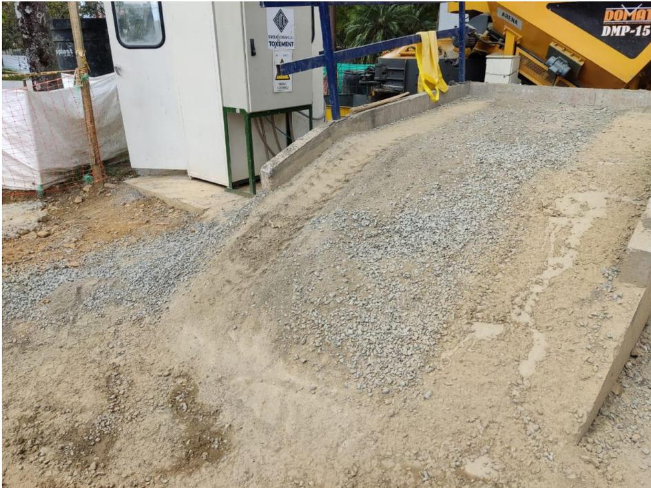
4. La dosificadora pasa el material al mezclador, dejando caer una parte en el proceso (**Figura 5** y **Figura 6**). Según las condiciones, una parte de la arena puede ser recuperable, pero si se combina con triturado, se moja o se contamina con tierra, el proceso para recuperarla se hace más complicado y se opta por tirarla. En este caso el mantener limpia toda la zona de la planta de concreto se vuelve muy importante.
