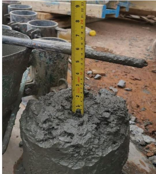
En la obra YKK, sede Rionegro, se utilizó concreto con la especificación "C. PLÁSTICO 4000 PSI TM 1" AIR FIBPO", como se ve en la **Fotografía 2**, para el vaciado de muros y losas del tanque RCI (**Fotografía 3**). Era esencial emplear un concreto que previniera fisuras y grietas, dado que el tanque debía contener un gran volumen de agua y cumplir con las resistencias exigidas.
