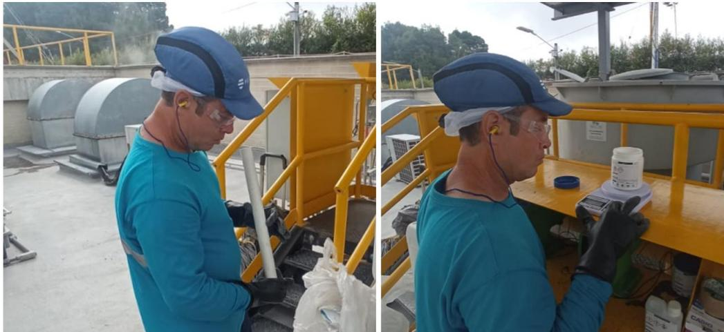
Como se puede apreciar en la figura 3, anteriormente las mediciones se realizaban visualmente utilizando un tubo, lo cual generaba una gran incertidumbre y podía afectar los parámetros de tratamiento y vertido. Ahora, las mediciones se llevan a cabo de manera más precisa y confiable utilizando una gramera y recipientes debidamente etiquetados.
