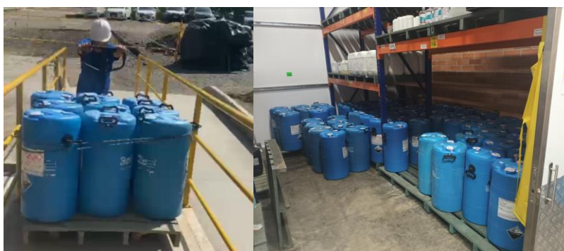
Figura 18. Transporte de alrededor de 350 kg con estibador Manual por rampa para ingresar al almacén (izquierda) y almacenamiento de cerca de 6 toneladas de hipoclorito de sodio en el cuarto químico del almacén (Derecha).
