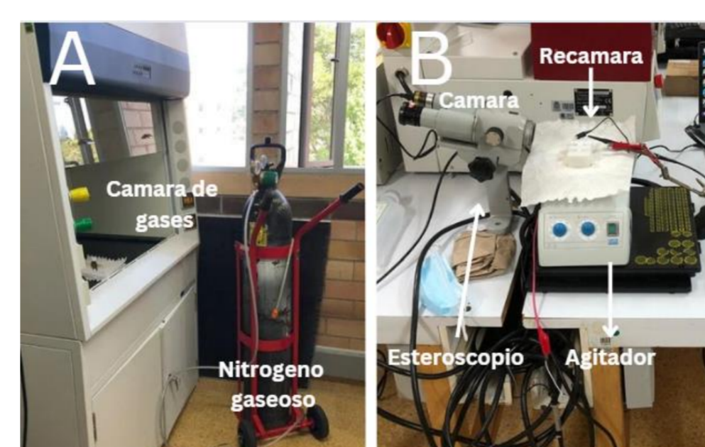
Fig 7. Montaje experimental para hacer BLM.
