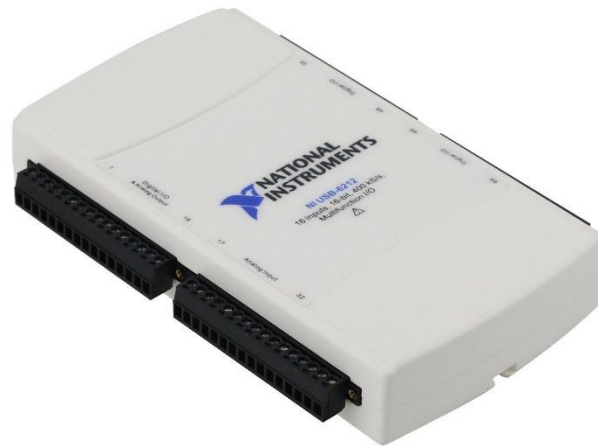
Fig. 16. Dispositivo DAQ USB-6212 de la empresa National Instruments
