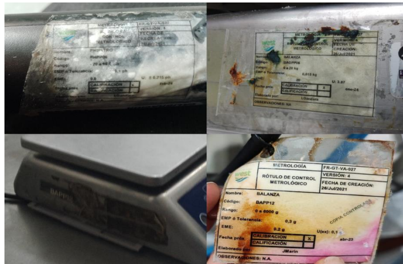
Fig. 2. Deterioro de rótulos de control metrológico en diferentes equipos
