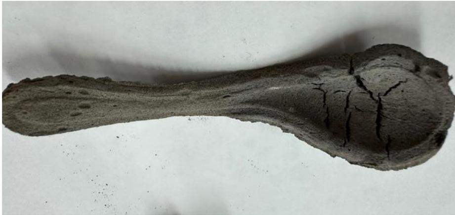
Figura 13. Cuchara obtenida con el molde de impresión 3D.
