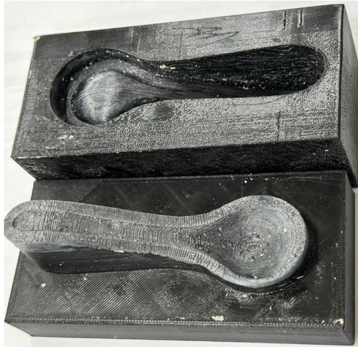
Figura 12. Molde obtenido de impresión 3D.
