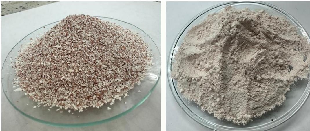
Figura 5. Cáscaras de huevo procesadas únicamente en licuadora y cáscaras de huevo después del proceso de molienda en licuadora, molino de bolas y tamizado.
