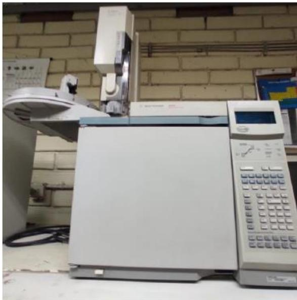
*Ilustración 19. Cromatógrafo gaseoso Agilent Technologies 6890N*
