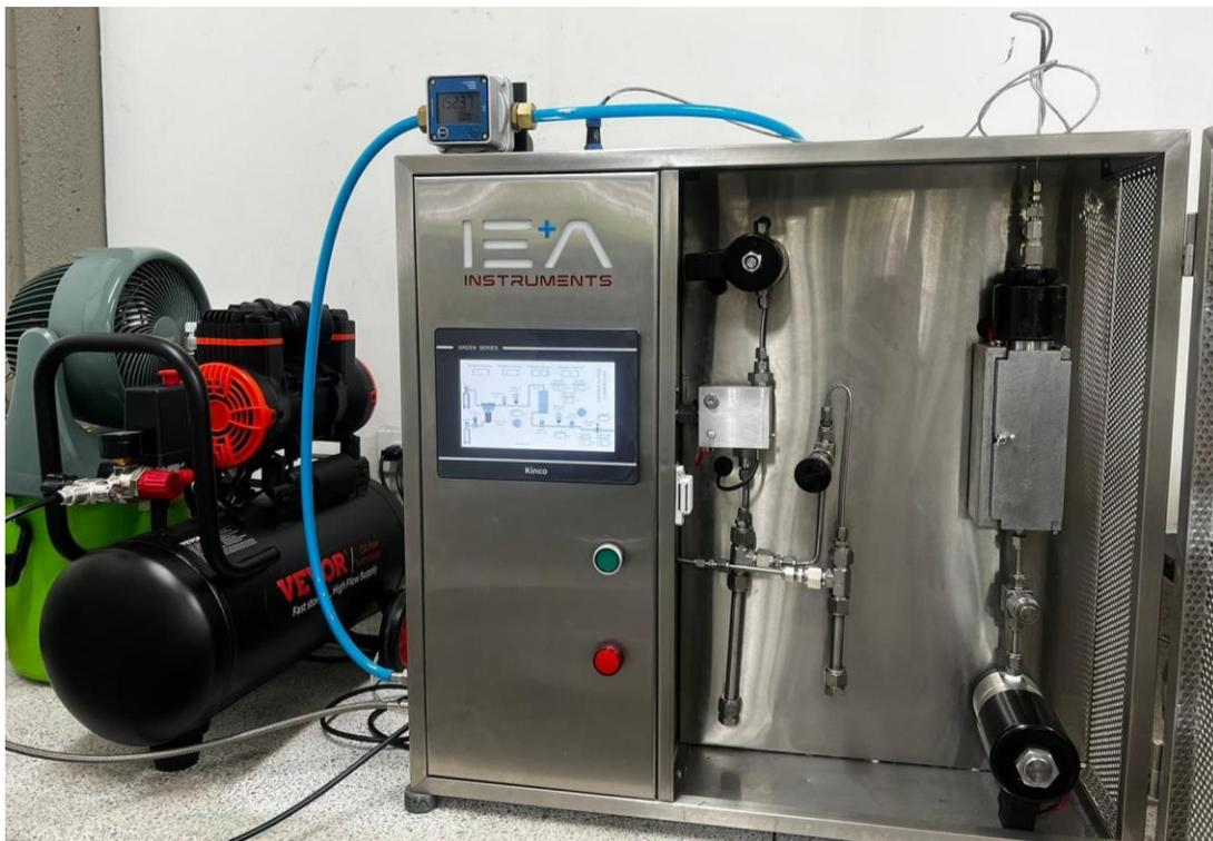
*Ilustración 13. Equipo de extracción de fluidos supercríticos EIA.*
