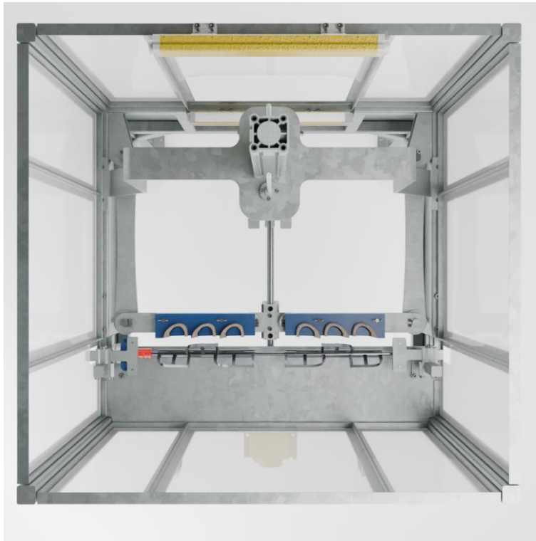
Figura 8. Posición 2 sistema tornillo de bolas recirculantes.
