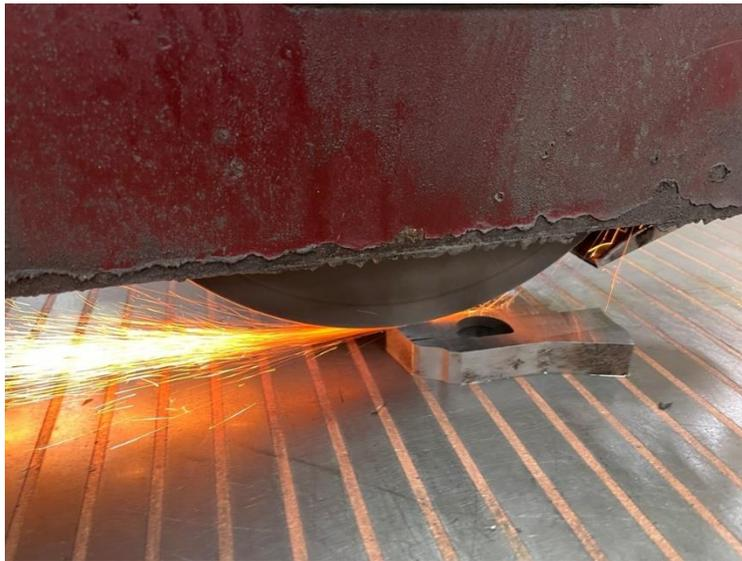
Fig. 11. Rectificado de macho cortador
