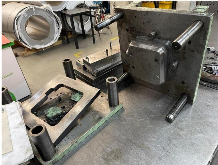
Fig. 7. Mantenimiento Preventivo Troquel embutidor semicoca
