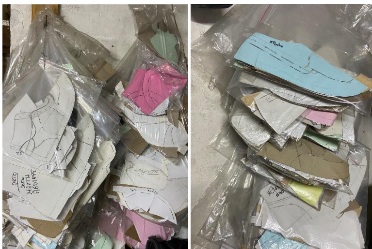
Imagen 18: Moldes en cartulina de diferentes estilos y tallas de zapatos.
