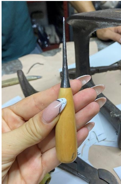
Imagen 15: Lezna usada para perforar el cuero.
