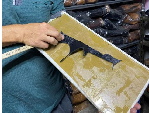
Imagen 14: Vidrio usado como base para cortar el cuero.
