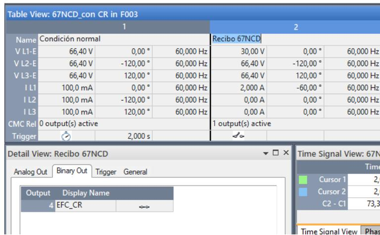
Fig. 45. Activación de la señal EFC\_CR en el State Sequencer
