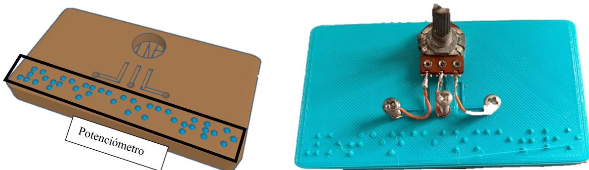
Fig. 12. Base con marcación braille para potenciómetro.
