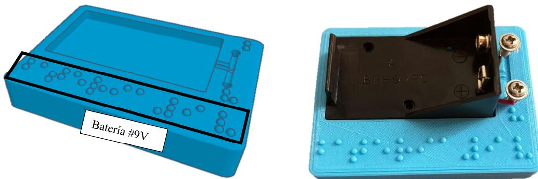
Fig. 9. Base con marcación braille par batería 9V.
