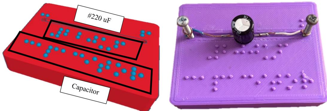
Fig. 17. Base con marcación braille para capacitor electrolítico de 220uF.
