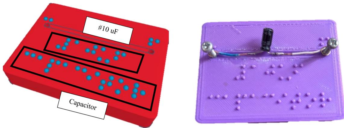
Fig. 16. Base con marcación braille para capacitor electrolítico de 10uF.
