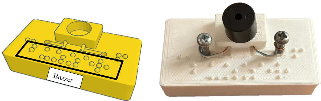
Fig. 11. Base con marcación braille para buzzer.
