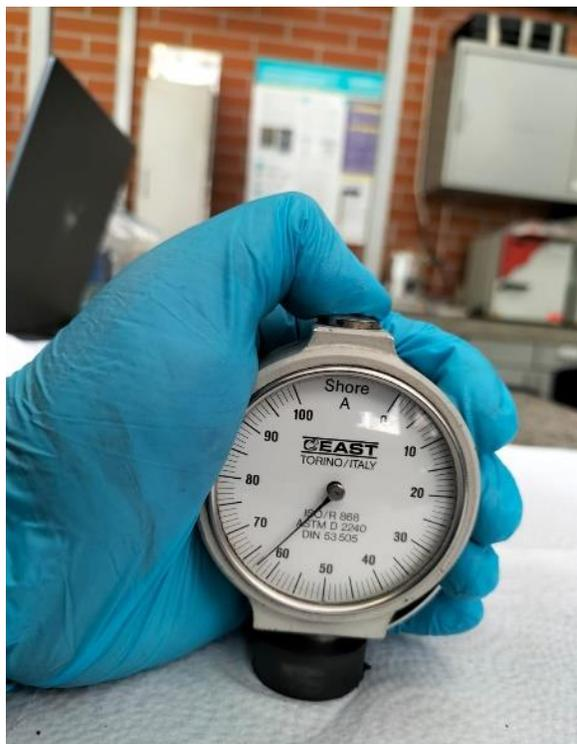
Figura 6. Medición de dureza Shore A.
