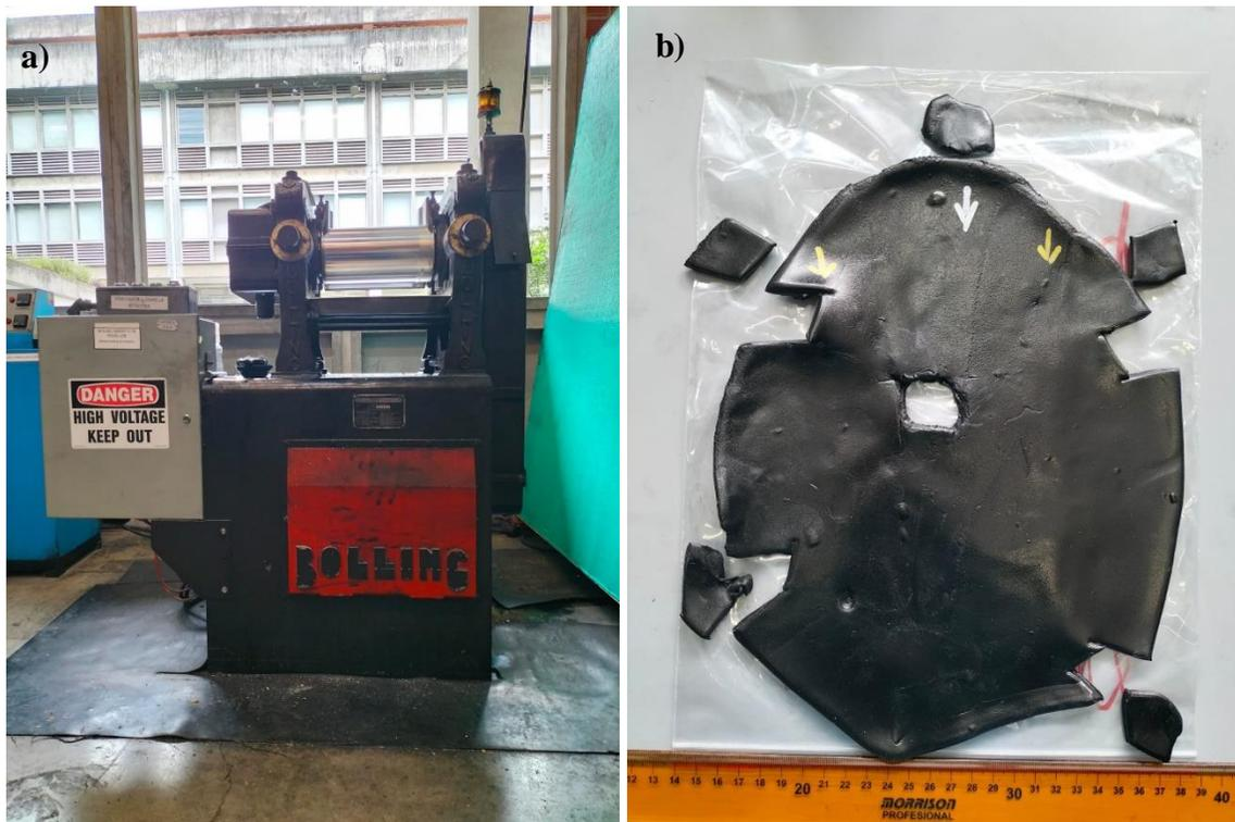
Figura 2. a) molino utilizado para la preparación de las mezclas, b) mezcla obtenida sin plastificante.
