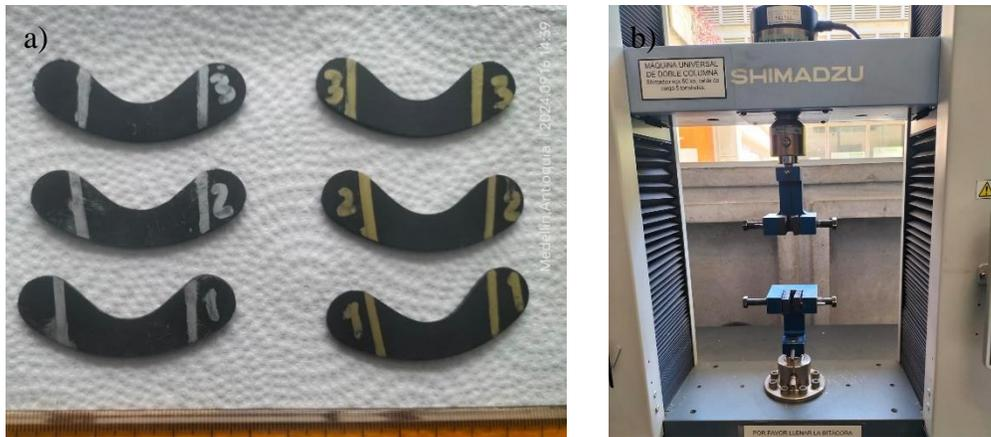
Figura 8. Montaje ensayos de desgarre, a) probetas tipo A y b) montaje para ensayo de desgarre
