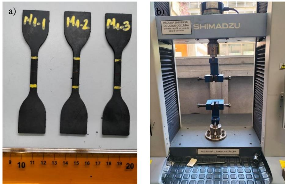
Figura 7. a) probetas tipo corbatín y b) montaje para ensayo de tracción.
