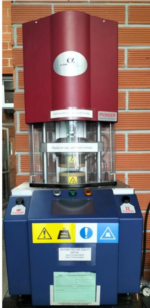
Figura 3. Reómetro de disco móvil serie Pioneer MDR
