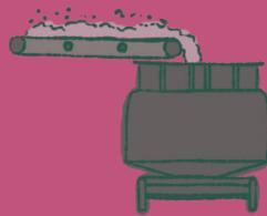
La materia prima se mezcla con hierro y caliza, se pulveriza y su composición química se evalúa y ajusta. Luego va a los molinos, donde se transforma en un polvo llamado crudo.
