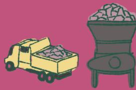
Las rocas se reducen hasta un tamaño aproximado de una pulgada de diámetro con el uso de trituradoras.
