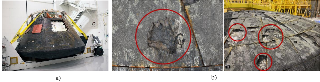
Fig. 3. a) Capsula Orión y b) Pérdida de carbonización del escudo térmico después de la misión Artemis I.
