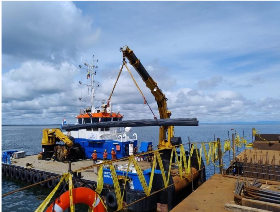
Ilustración 32. Multicat descargando material. Fuente: Elaboración propia
