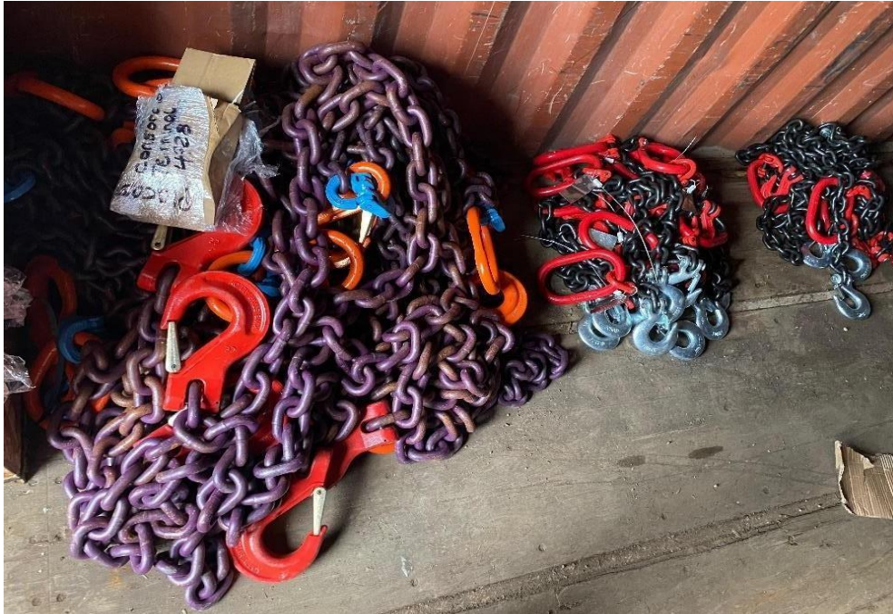
Ilustración 27. Eslingas de cadena con acortador de cadena y gancho de seguridad.
