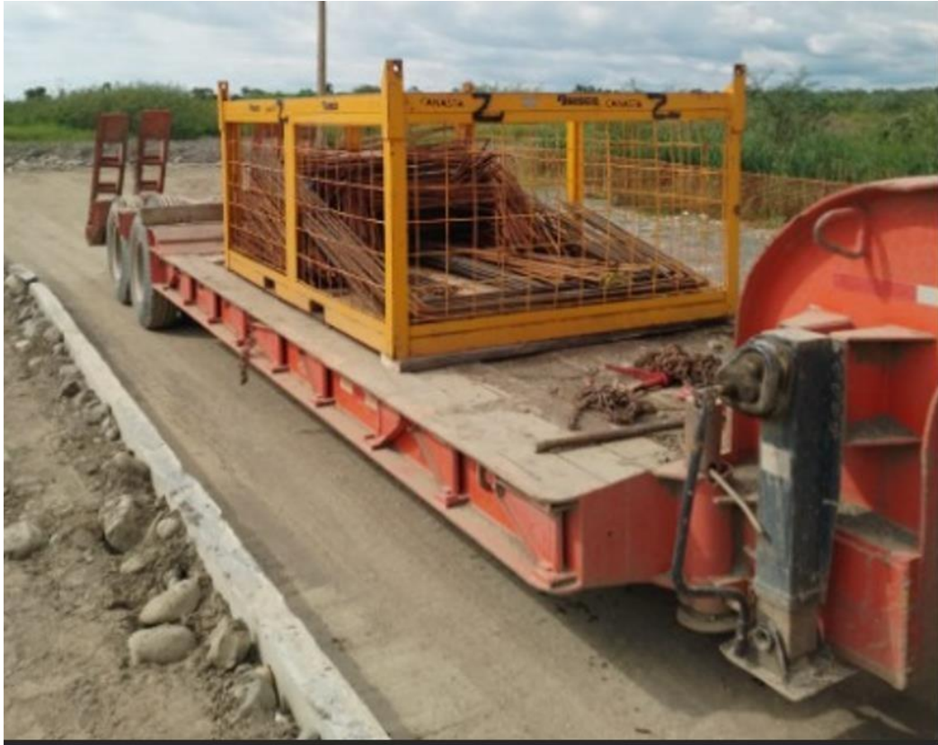
Ilustración 20. Transporte de canasta de material sobre cama baja. Elaboración propia
