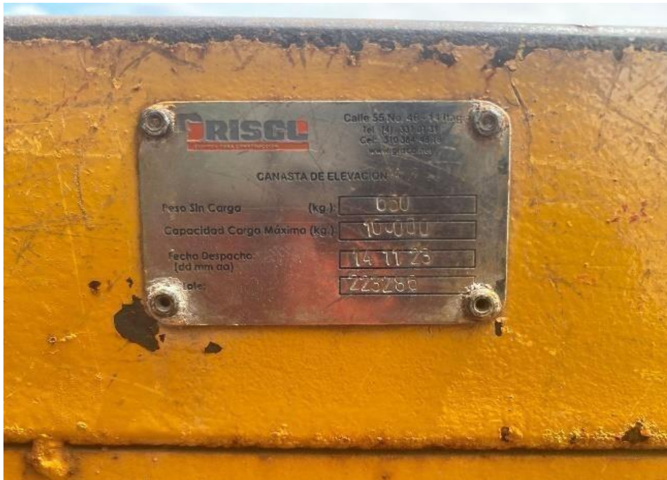
Ilustración 21. Ficha técnica de la canasta de 3 metros x 2 metros. Elaboración propia
