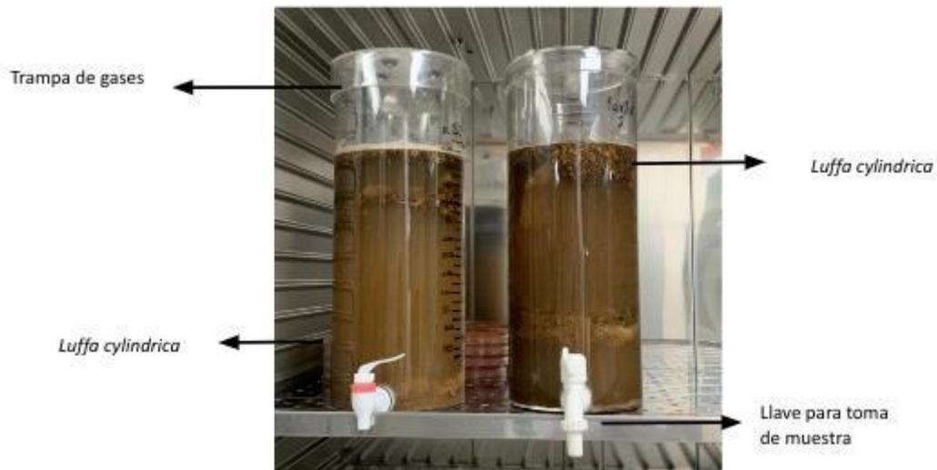
**Imagen 1.** Biorreactores utilizados para el tratamiento del efluente contaminado con R40 previo a la adición de colorante e inoculación con el hongo. Fuente propia.
