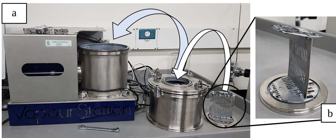
Figura 3. a. Cámara evaporadora y ensamble de sus componentes, b. Aditamento de aluminio que modifica la distancia desde el filamento hasta el sustrato.
