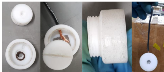
Figura 7. Porta muestras utilizado en el anodizado de las muestras.
