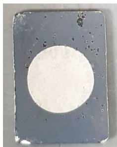
Figura 8. Muestra de Mg con capa de Zn depositada, tratada térmicamente y anodizada con el porta muestras diseñado.
