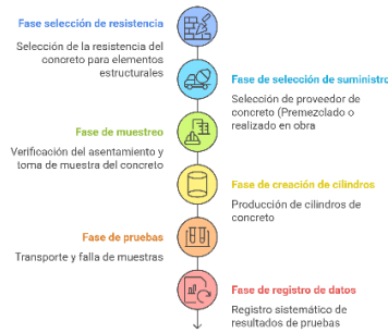
Figura 3: Esquema de flujo para ilustrar la metodología de trabajo. Fuente: Elaboración propia
