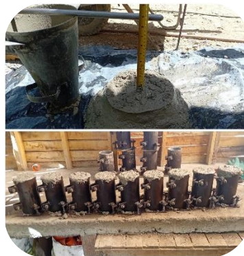
Figura 2: Toma de asentamiento y muestras cilíndricas para compresión. Fuente: Elaboración propia
