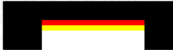
Figura 4: Imagen blanca en fondo negro observada a través del prisma- parte superior
