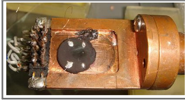
Figura 13. Equipo para medir la resistividad por el método de las cuatro puntas
