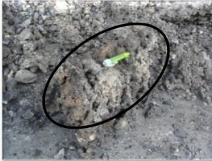
Figura 6. Fotografía tomada a la escoria producida en la EMPRESA 3.
