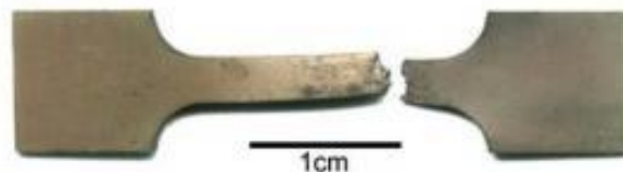
Figura 16. Probeta de termofluencia del acero con 20%Ni, 14%Cr y 2.5% Al, ensayado a 750° C, con una tensión de 100 MPa, al aire, durante 2191 horas. Se ve poca oxidación.
